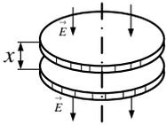
**Решение** При движении металлических дисков на них наводится заряд такой, чтобы поле между дисками было равно 0. Это дает условие для определения заряда на каждом из дисков:
