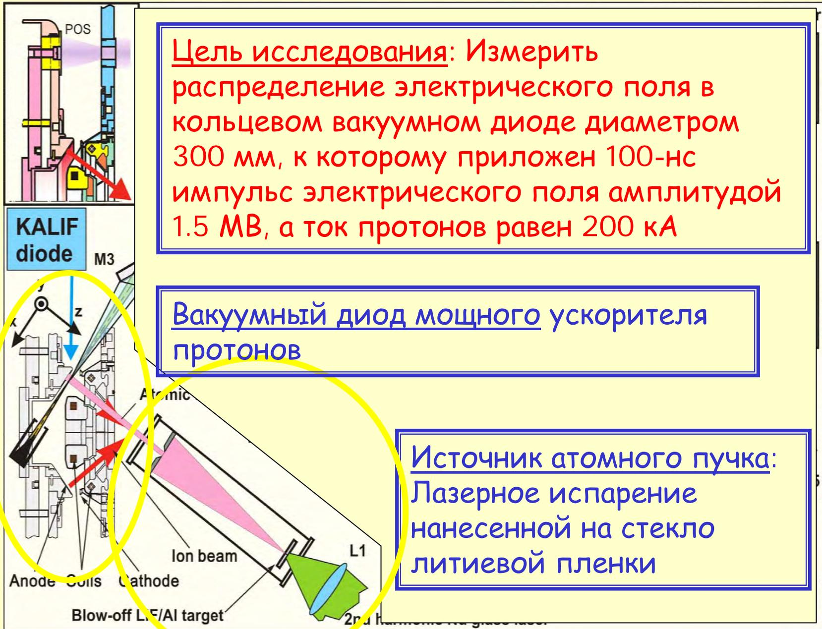
Цель исследования: Измерить распределение электрического поля в кольцевом вакуумном диоде диаметром 300 мм, к которому приложен 100-нс импульс электрического поля амплитудой 1.5 МВ, а ток протонов равен 200 кА
