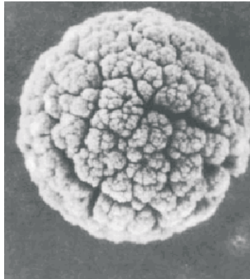
Рис. 14.18. Пылевая частица, выросшая в гелиевой плазме с графитовыми электродами; ВЧ-разряд, 15 МГц, 1 Тор [120]
