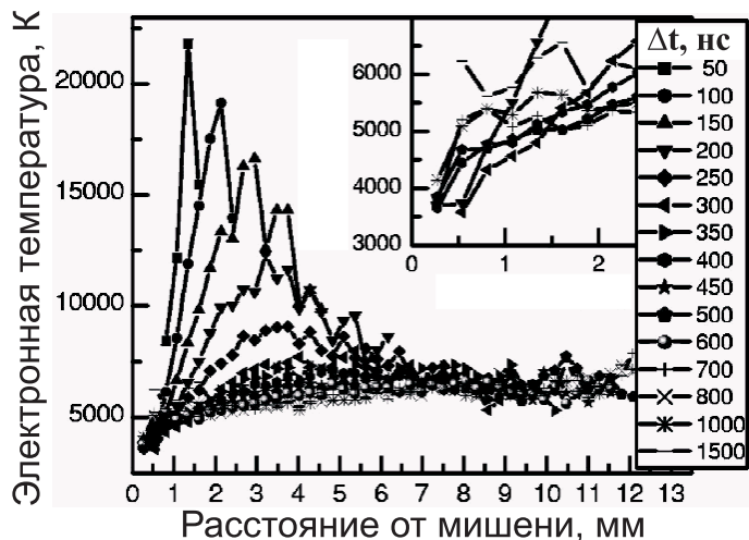
Рис. 14.3. Пространственное распределение электронной температуры в циркониевом облаке как функция времени [87]; график в верхнем правом углу более подробно показывает распределение температуры вблизи мишени
