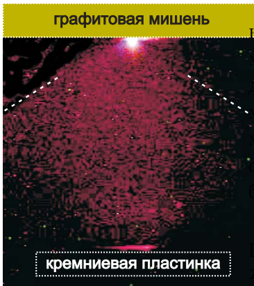
Рис. 14.1. Интегральная съемка плазменного облака, полученном при фокусировке излучения КгF-лазера на поверхности графитовой мишени (фото автора)
