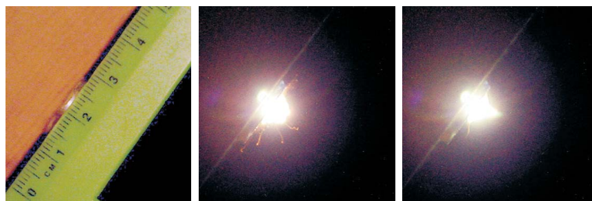
Рис. 14.4. Факел, образующийся при облучении KrF-лазером расположенной в воздухе дюралюминиевой мишени (фото автора)
