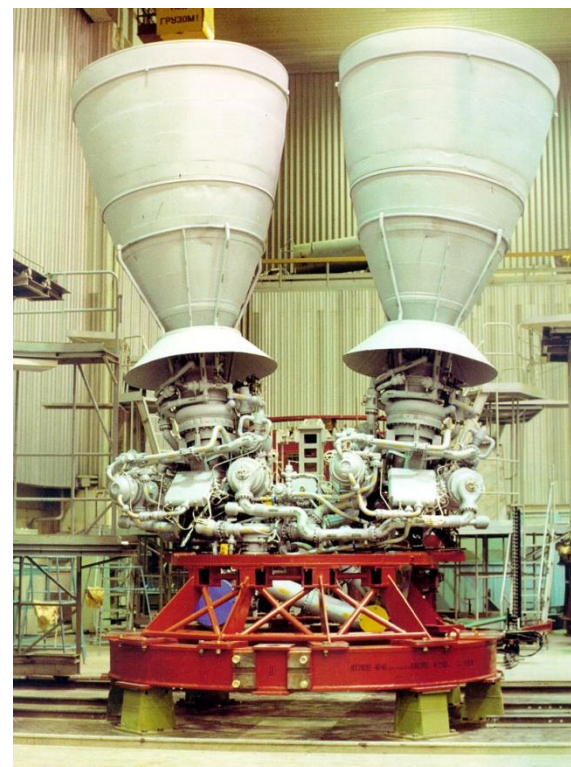
РД-701 – трехкомпонентный двигатель (водород кислород - керосин)
