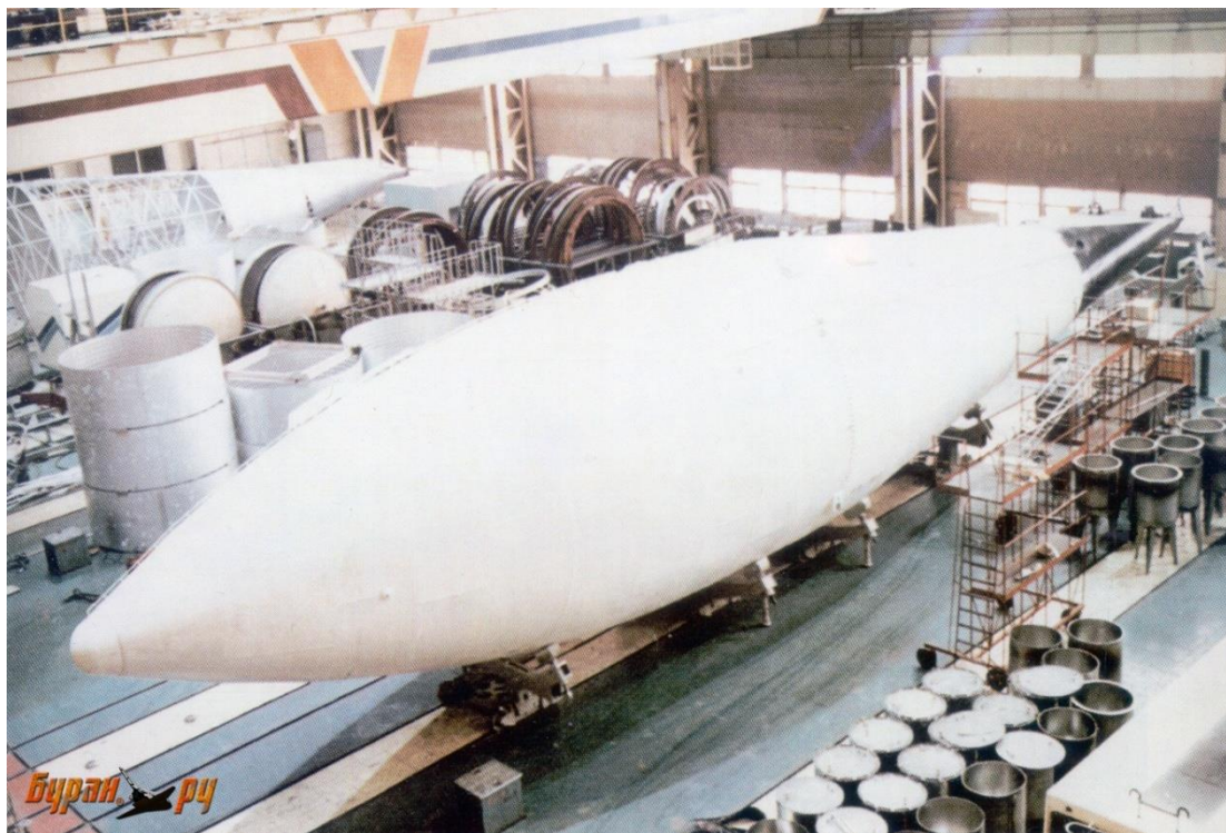
Внешний топливный бак 2 ступени для криогенных компонентов топлива
