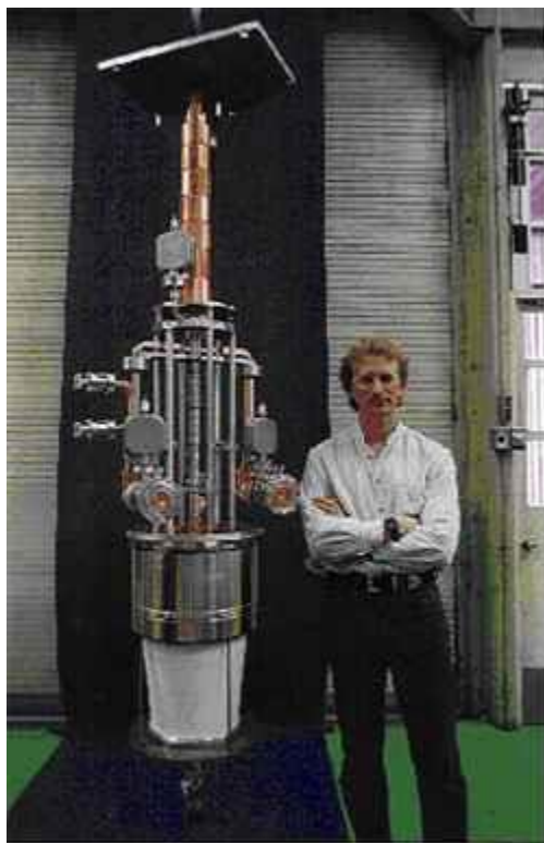
75-мегаваттный клистрон, частота 11.4 GHz, импульсы до 3 мкс
