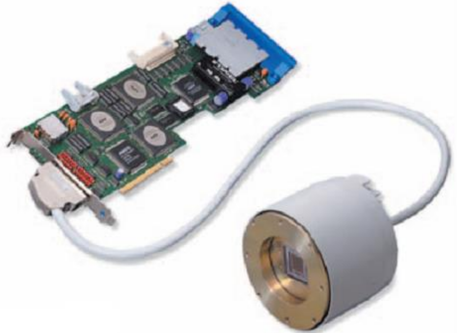
ПЗС-камера высокого разрешения ТН8730 (Thales)
