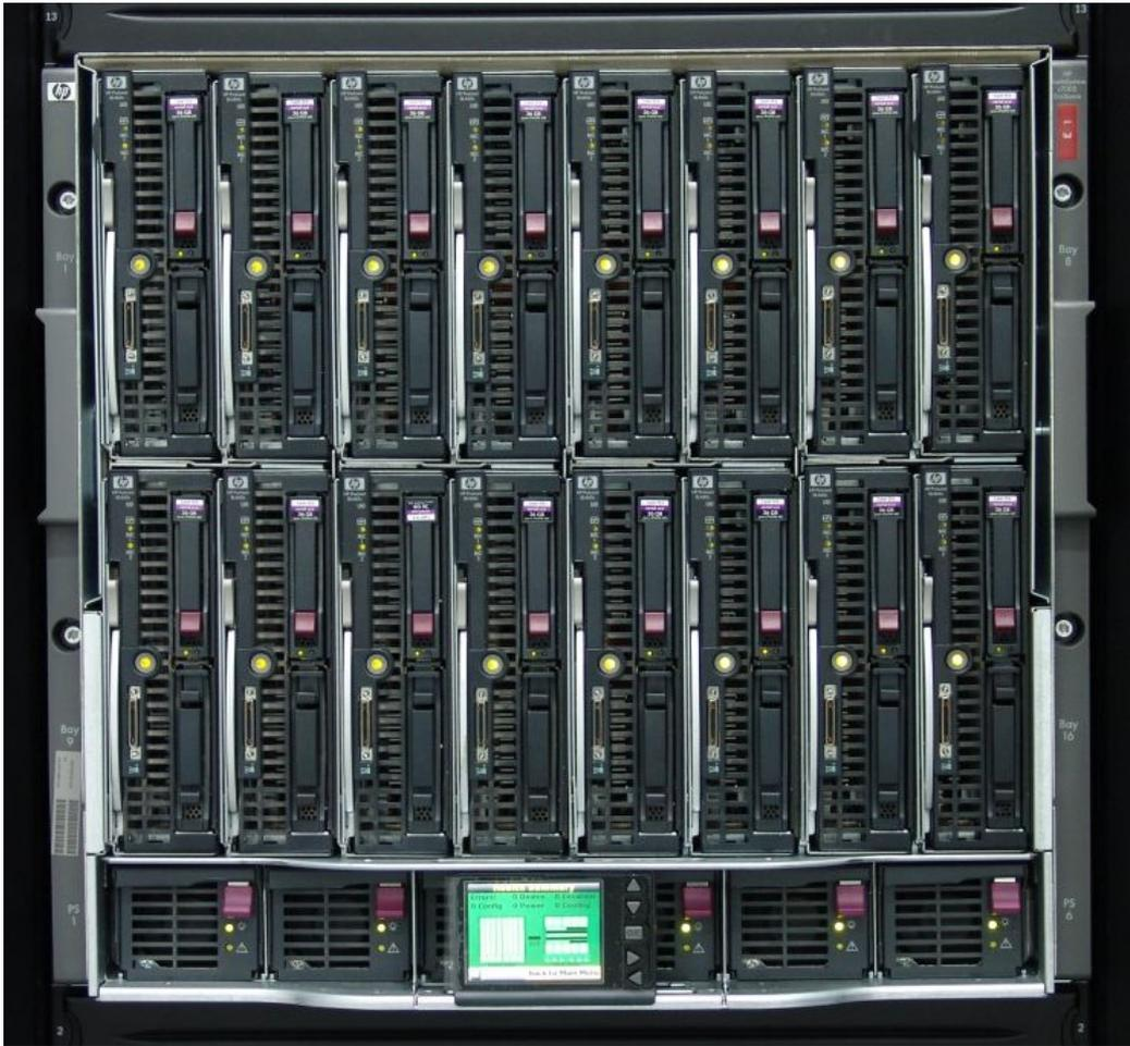
64 вычислительных узла первой очереди, запущенной в 2008г, установлены в 4х серверные полки (шасси) HP BladeSystem c7000, каждая из которых содержит:
