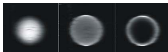
Рис. 3. Профили пучка при потенциале управляющего электрода 0, +100, +300 В и потенциале анода +500 В
