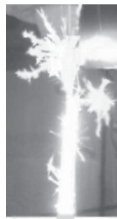
Рис. 2. Факел горения топлива 3. Горизонтальная полоска в нижней части изображения – срез стаканчика диаметром 1 см
