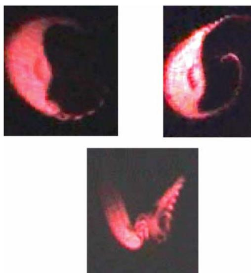
Рис. 10. Картины дымовой визуализации поперечного сечения струи, подверженной вторичной высокочастотной неустойчивости при акустическом воздействии на нее
